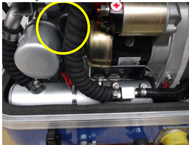
Fig. D.3.6-4: Comondulateur à pression d'huile
