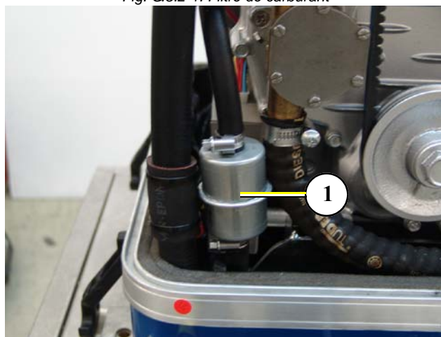
Fig. G.5.2-1: Filtre de carburant
