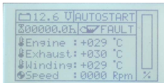
Fig. K.4.6-7: Page standard d'écran en mode de démarrage
