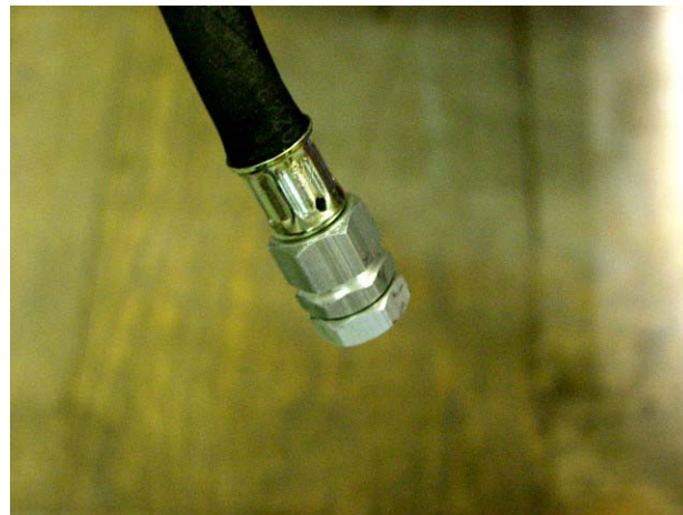
Fig. F.7-2: Tuyau de vidange d'huile
