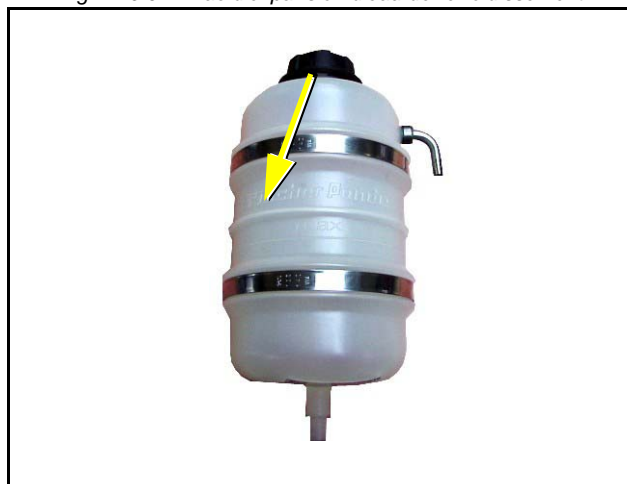
Fig. F.10.0-4: Bac d'expansion d'eau de refroidissement
